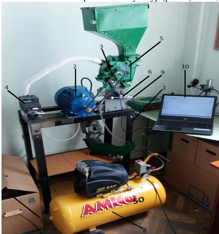
Рис. 5. Лабораторная установка для исследований пневматических высевающих аппаратов: 1 – рама, 2 – электродвигатель постоянного тока, 3 – приводная цепь, 4 – частотный преобразователь, 5 – экспериментальный высевающий аппарат, 6 – семяпровод, 7 – вакуумная установка с регулятором разрежения, 8 – компрессор, 9 – датчики измерения скорости семян на выходе из семяпровода, 10 – персональный компьютер
